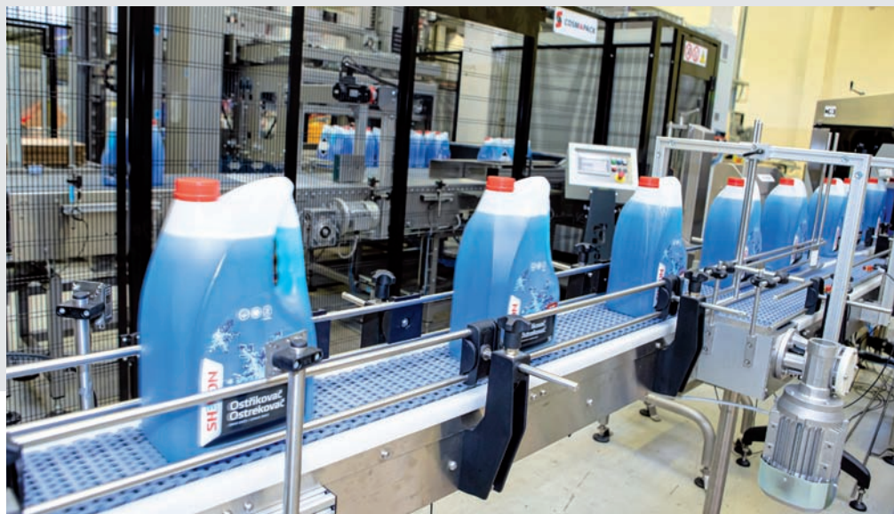
Plne automatizovaná linka je zložená z niekoľkých samostatných zariadení a umožňuje plniť až 11 rôznych typov obalov.
